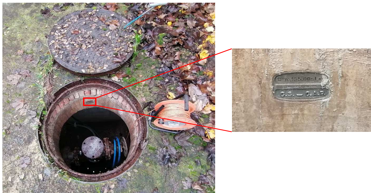
Figura 15 Misurazione del livello statico dell'acqua di falda presso il pozzo 0150120006, con zoom relativo alla targhetta segnalatrice di quota del piano campagna (in m s.l.m.)
